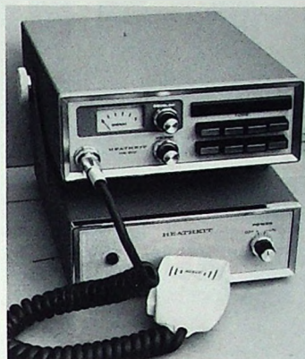
Bild 1. 2-m-FM-Transceiver „HW-202“ mit Autohalterung und (darunter) Netzversorgungsgerät „HWA 202-1“ für Heimbetrieb
