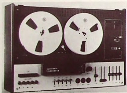
Bild 10. Hi-Fi-Tonbandgerät „magnetophon 3002 hifi“ mit eingebauter Endstufe
